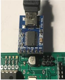
Bij het gebruik van een FTDI breakout printje moet je kijken waar de GND zit en deze laten corresponderen met de GND op de OTGW print.
